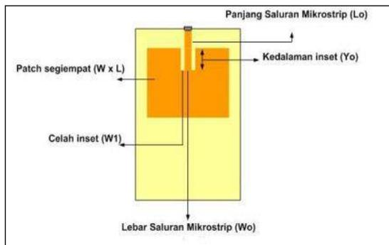
Gambar 1. Spesifikasi antenna yang dirancang
