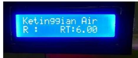
Gambar 16 Tampilan Pengujian Sensor Ultrasonik pada LCD display
