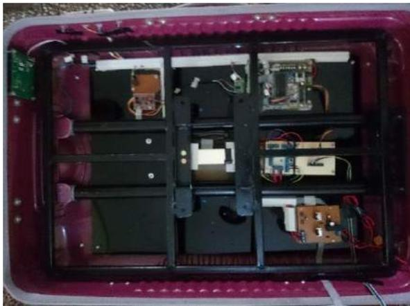
Gambar 5. Rangka Penimbang pada Koper
