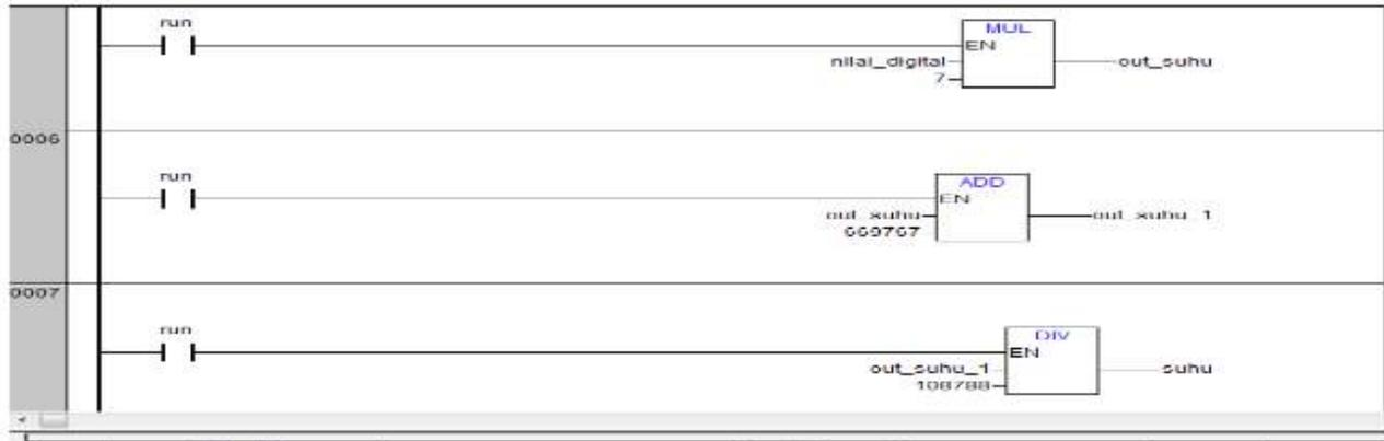
Gambar 4. Tampilan pemrograman ladder diagram untuk pembacaan suhu
