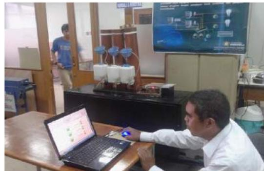
Gambar 7. Pengujian pengiriman data monitoring indikator motor berkerja.
