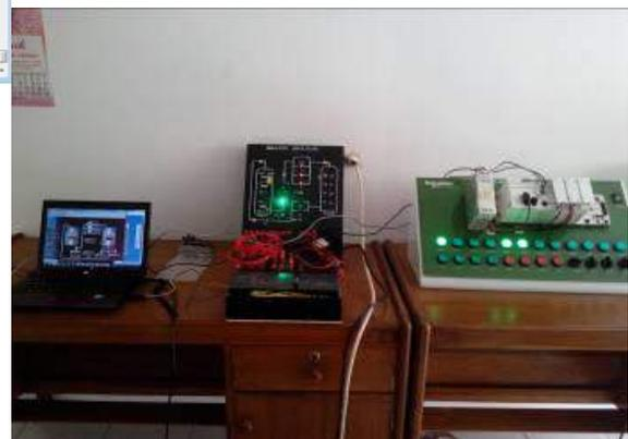
Gambar 7. Pengujian koneksi satu PC dengan dua PLC
