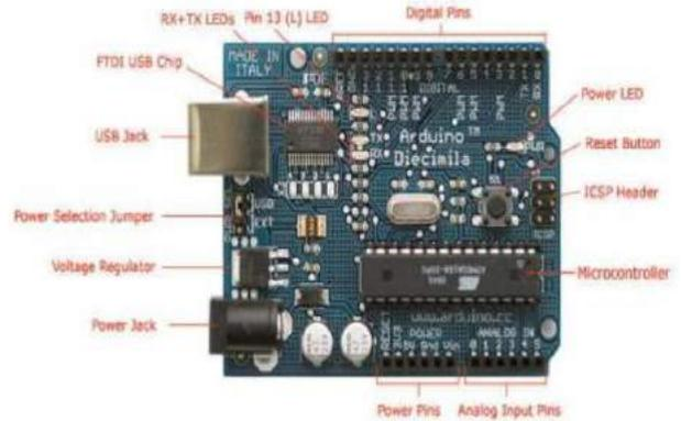
Gambar 4 Mikrokontroler arduino uno
