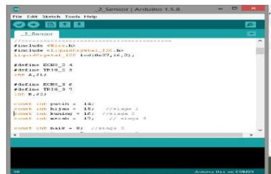
Gambar 7. Program sensor ultrasonik pada *Arduino* IDE
