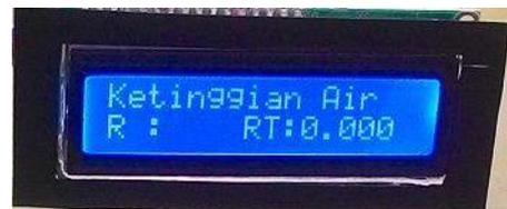
Gambar 15 Tampilan Pengujian Sensor Ultrasonik pada LCD display
