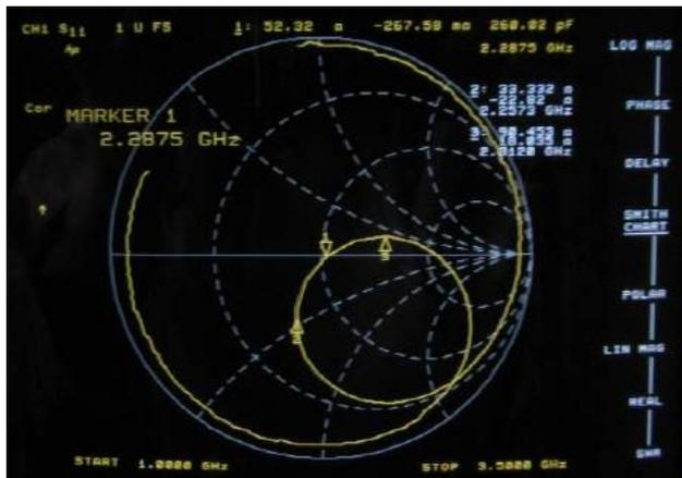
**Gambar 10.** Plot *Smith chart* antenna mikrostrip segiempat substrat NHL 4806 *grade* FR4, pada hasil pengukuran
