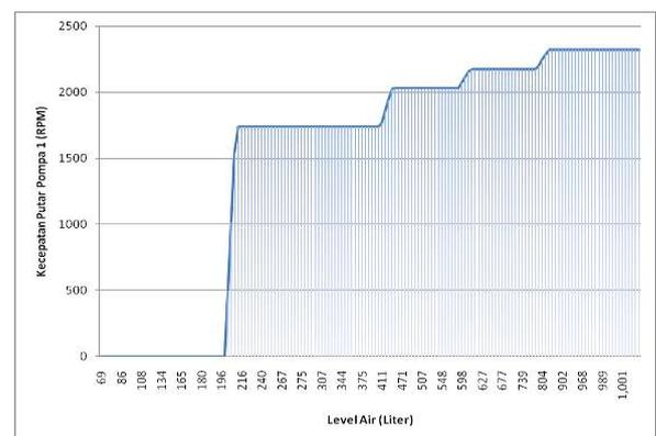
Gambar 5. Grafik perbandingan kecepatan motor dengan level air (Tangki 1)
