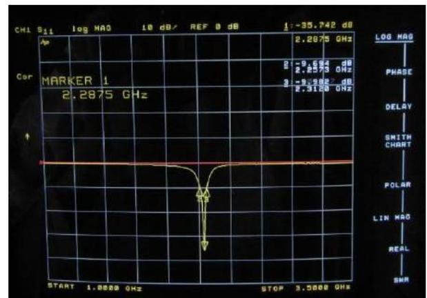
**Gambar 9**. Plot *return loss* antenna mikrostrip segiempat substrat NHL 4806 grade FR4, pada hasil pengukuran
