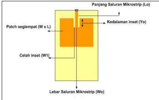
**Gambar 1. Spesifikasi antenna yang dirancang**
